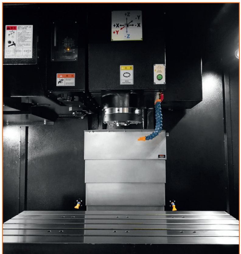
Keyarrow Teleskopabdeckungen in allen Achsen
