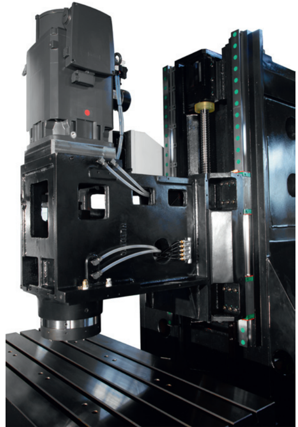
Schwerer Meehanite Gusskörper zur optimalen Schwingungsdämpfung
